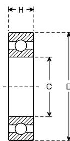
Roulements à billes économiques, avec deux flasques métalliques. Principalement conçus pour les montages où la bague intérieure tourne.
